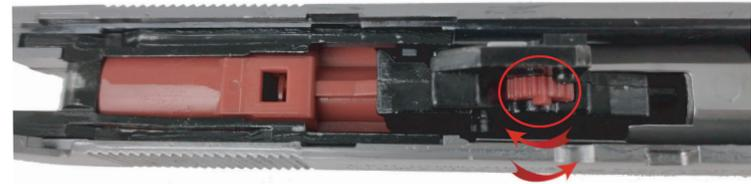
Sie haben dann Zugang zum Einstellrad des Spin-Ups. Sie können das Einstellrad durch drehen nach links festziehen und durch drehen nach rechts lösen.
