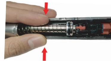
Um den Wiedereinbau des Schlittens zu erleichtern, klemmen Sie die Federführungsstange ein, um sie zu zentrieren, bevor Sie den Körper unter den Schlitten schieben. Vorsicht, die Feder muss zusammengedrückt werden, damit sie in den Stopfen passt. Achten Sie darauf, sie beim Zusammenbau des Schiebers festzuhalten.
