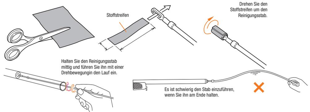
Halten Sie den Reinigungsstab mittig und führen Sie ihn mit einer Drehbewegung in den Lauf ein.
