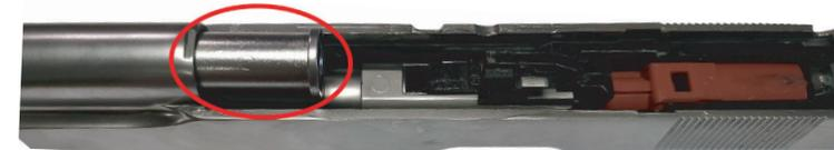
Um den Schlitten wieder zusammenzubauen, muss die Federführung wieder in seine Position gebracht werden.
