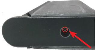
Befüllen Sie das Magazin mit einem geeigneten Gas. Halten Sie die Gasflasche während dieses Vorgangs senkrecht. Befüllen Sie das Magazin über das Füllventil, welches sich auf der Unterseite des Magazins befindet.
